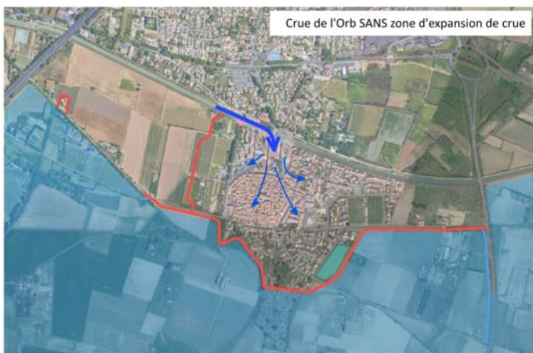
Principe de fonctionnement de la zone d'expansion de crue (Source : EGIS)
