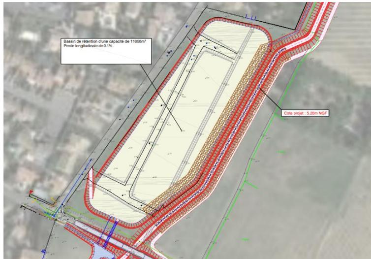
Figure 14 : Plan du bassin de rétention (source : EGIS)
